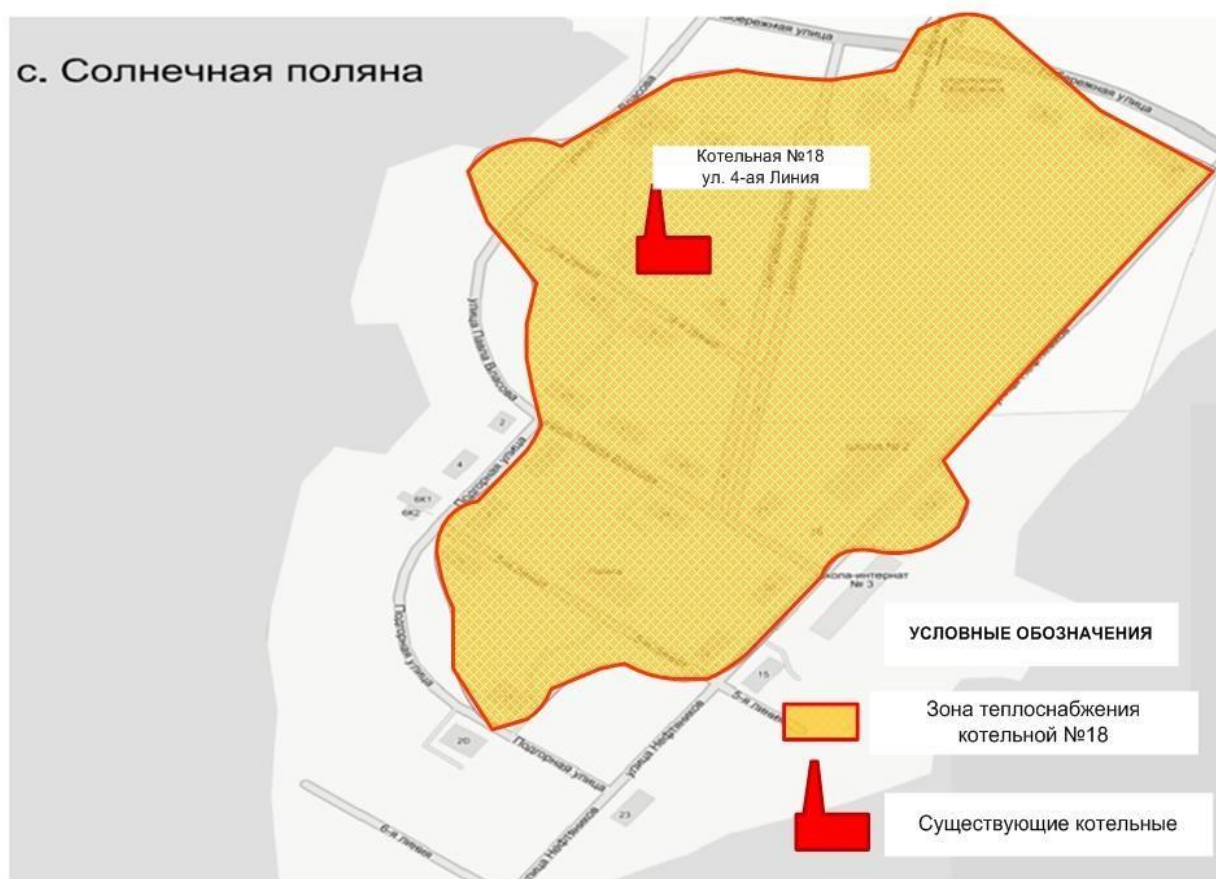
Рисунок 2.1.4 –Зона действия системы теплоснабжения котельной №18
