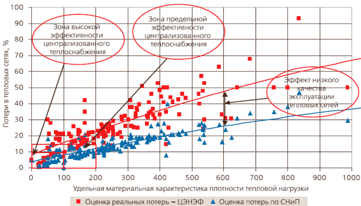
Рисунок 7.11.1 – Зависимость потерь в тепловых сетях от удельной материальной характеристики тепловых сетей
